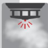
● **le détecteur et avertisseur autonome de fumées (DAAF)** : à implanter en priorité dans les couloirs et les chambres d'enfants. Il doit être fixé le plus haut possible à distance des sources de vapeur (cuisine, salle d'eau) ;
